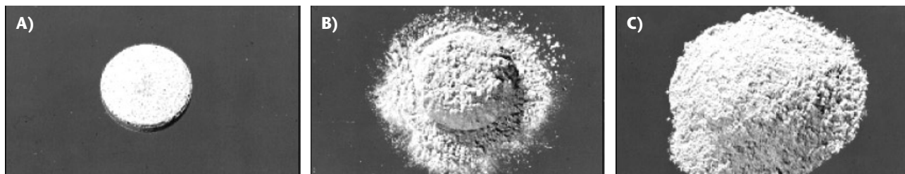
Figura 1. Tableta de fosfuro de aluminio. A) Recién colocada. B) Reacción de liberación de fosfina. C) Fosfina totalmente liberada.
